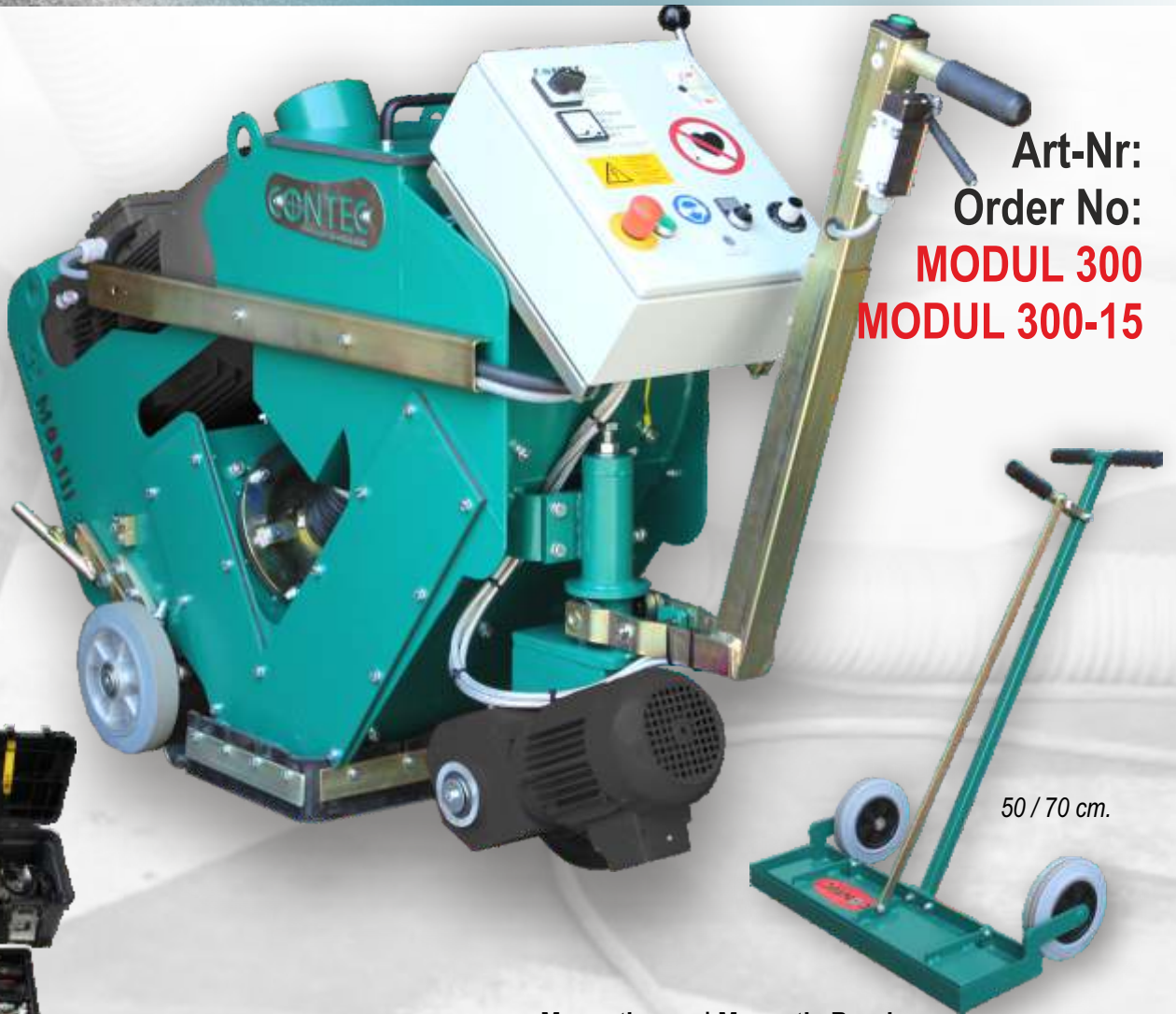
Mit dem Magnetbesen wird liegen- gebliebenes Strahlmittel aufgelesen.
